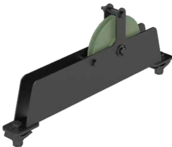
Composé d'une carcasse acier, d'une poulie en PA6 ou acier (multigorges de 1 à 8 câbles) avec roulements à billes étanches, de 2 crapauds de fixation en acier moulé avec boulons M12. Largeur adaptable sur mesure.
