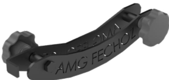
Avec système anti-déboîtement, ce qui évite toute chute lors des maintenances. Blocage par 2 écrous étoiles Ø 50 mm. Conçu pour des tiges de contre-poids de 220 mm et de section 30 mm.
